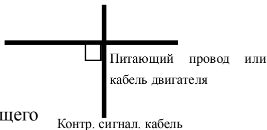
Рис.3-21 Требования к подключению системы
