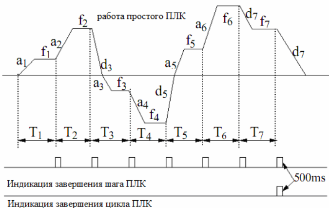
Рис. 6-19 работа простого ПЛК
