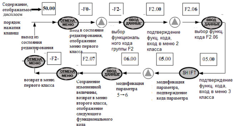
Рис. 4-7 Пример установки и изменения параметра
