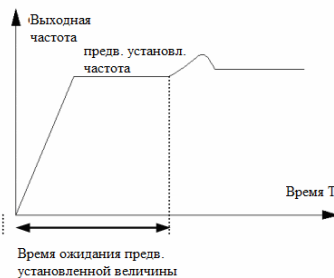
Рис. 6-18 предварительно установленная частота замкнутого контура
