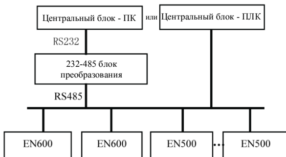
Рис.А-1 Схема построения сети
