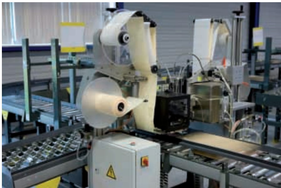
Этикетировочная машина управляется ПЛК серии MELSEC L.
