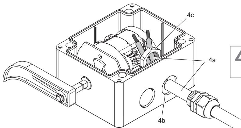
**4** Введите провод (а) в основание концевой выключателя (b), пропуская его также через установочная гайка (с).
