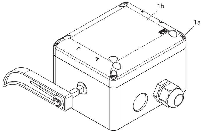
**1** Отвинтить 2 винта (а) и снять крышку (b).
