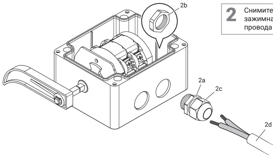
**2** Снимите кабельный ввод (а-б-с) и отвинтите зажимная гайка (с) для облегчения ввода провода (d).
